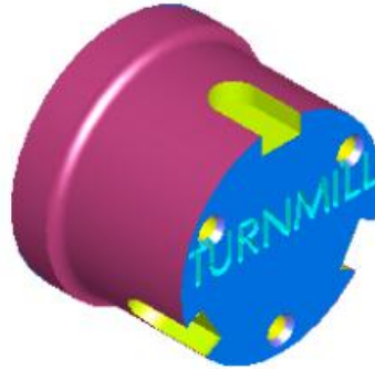
Рисунок 7 – Результат обробки на токарно-фрезерному верстаті
