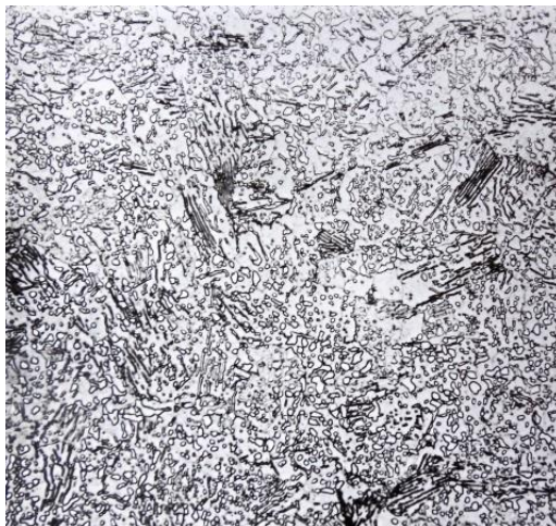
Рисунок 11 - Мікроструктура сталі (0,4%С) після ТЦО в інтервалі температур 1150 – 1300К, x100
