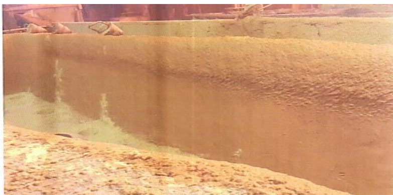
Рисунок 10 – Вид футерівки проміжного ківша після загладжування торкрет шару в зоні сталі
