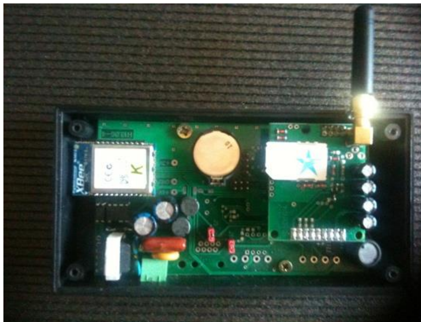
Рисунок 4.5 – Модем-координатор «Сигма RF»
