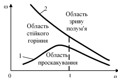
Рисунок 3 - Межі стійкої роботи пальника попереднього змішування: 1 - межа проскакування полум'я; 2 - межа зриву факела
