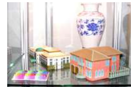
Цветные модели после 3D проектирования и изготовления по технологии Rapid Prototyping – быстрое прототипирование
